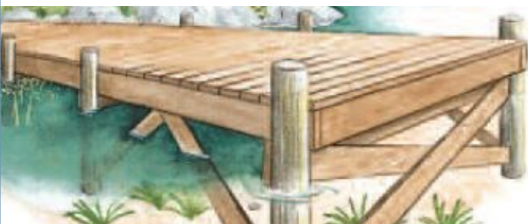
Quai sur pieux permanents
